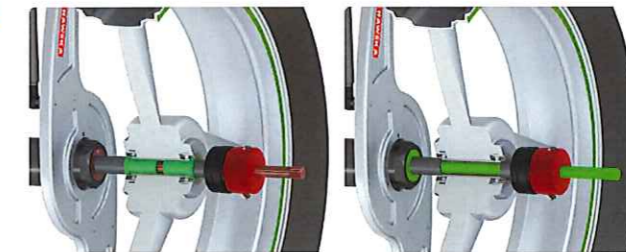
センターリングスリーブ取付
