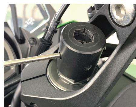
**!** 本製品は樹脂製です、静荷重で作業してください。衝撃的な荷重を加えると破損する恐れがあります。使用トルクの範囲内で使用してください。また回転方向にガタ（隙間）が大きくなった場合は新しい物に交換してください。
