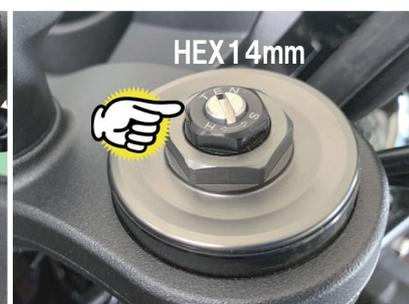
フォーク上面のフォークスプリングプリロードアジャスタ。車種によってサイズが異なりますので、適したサイズにて使い分けてください。
